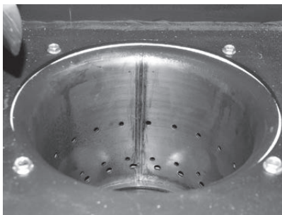
Fig. 50 Sekundärluftlöcher im Brennertopf reinigen
