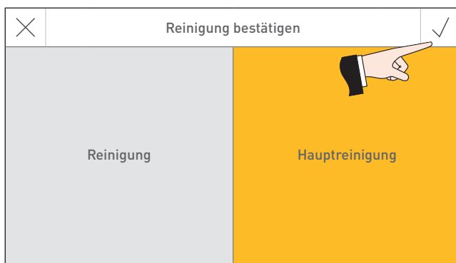
Fig. 29 Reinigung oder Hauptreinigung bestätigen
