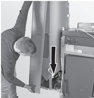
Fig. 71 Blende nach unten schieben und abnehmen (Bajonettverschluss)
