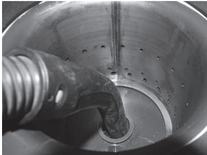
Fig. 51 Primärluftrohr in der Mitte des Brennerkopfes aussaugen
