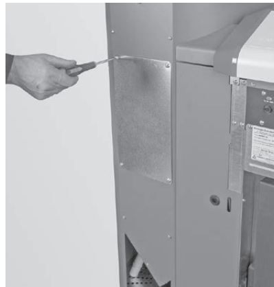
Fig. 72 Schrauben entfernen, Revisionsdeckel abnehmen
